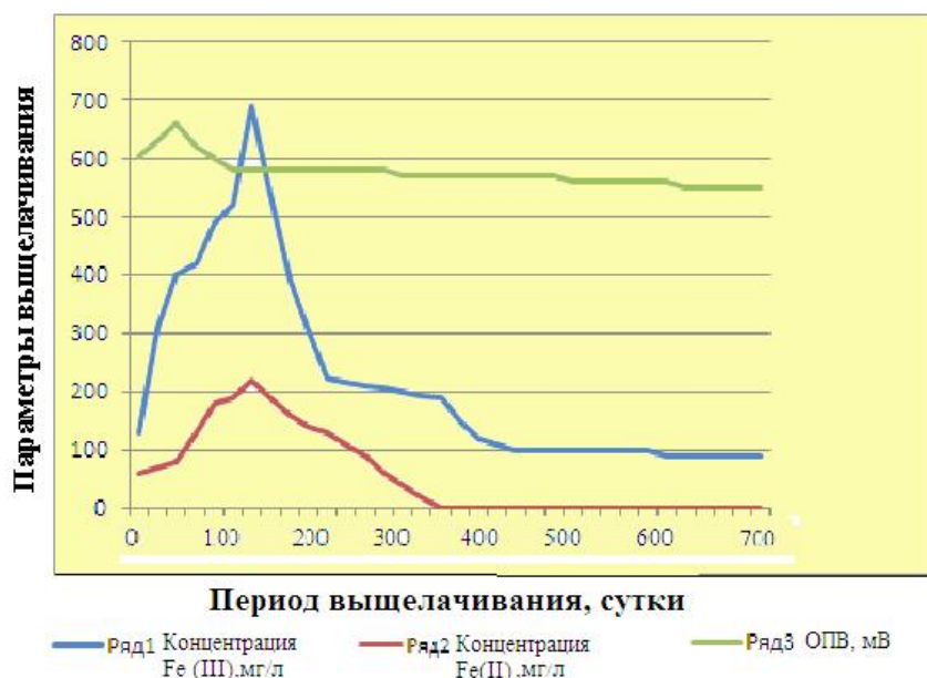
Рис. 3. Зависимости перехода в раствор в процессе выщелачивания ионов двухвалентного и трехвалентного железа и изменение окислительно-восстановительного потенциала среды от времени выщелачивания / Fig. 3. Dependence of transition to solution during leaching of ferrous and ferric ions and change of redox potential of medium on leaching time
